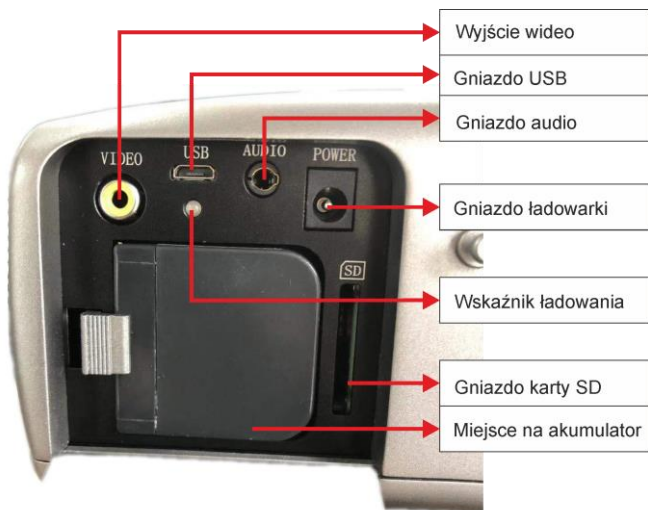
Rys. 15. Rozmieszczenie gniazd pod osłoną.
